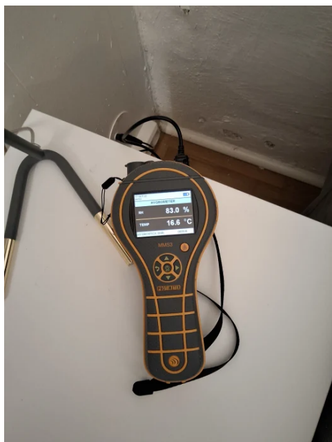
Bilde fra fuktmåling i veggkonstruksjon på soverom.
