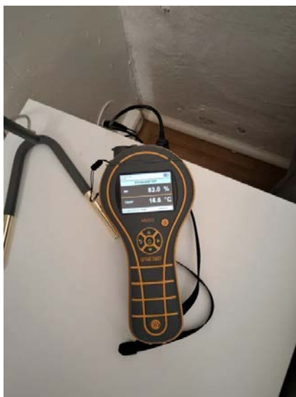
Bilde fra fuktmåling i veggkonstruksjon på soverom.
