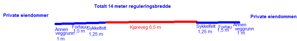
Figure 1: Prinsippsnitt for o_SKV9 med tilgrensende anlegg
