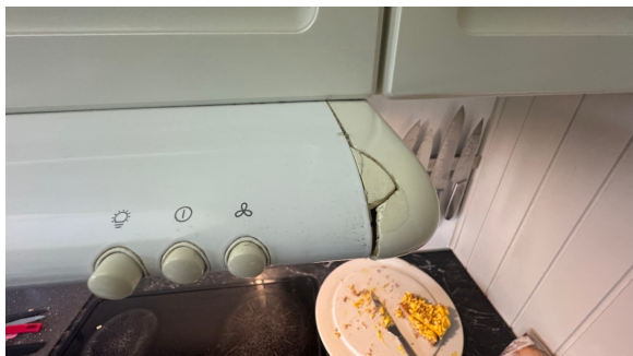
Sprekk i ventilator.
