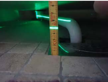
Referansenivå laser til topp membran ved dør = 5 cm. Viser ca. samme høyde.
