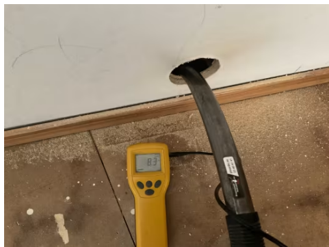
Resultat av fuktmåling viser ca. 8%
