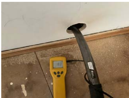
Resultat av fuktmåling viser ca. 8%
