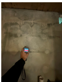
Piggmåling i trevirke 16,8 vekt% fuktighet.
