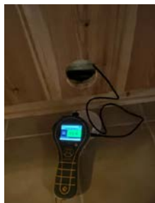
Piggmåling i trevirke 16,8 vekt% fuktighet.
