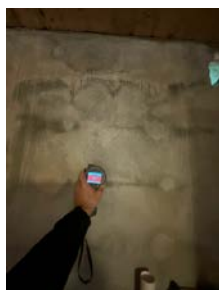
Piggmåling i trevirke 16,8 vekt% fuktighet.
