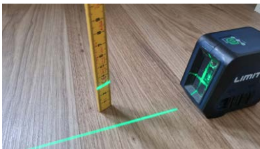
Kontroll av planavvik.
