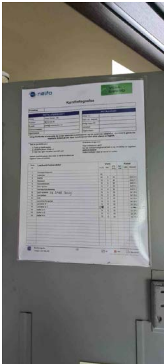
Skjema: "Brannforebyggende Elkontroll Bolig: Elkontroll bolig NEK 405-2-2" Spørsmål: Merknad Beskrivelse: Kursfortegnelse, noe mangelfull, mer for informasjon., Filnavn: IMG_20241002_112452.jpg
