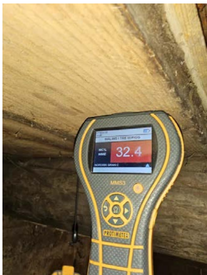
Bilde viser fuktmåling i kjeller.
