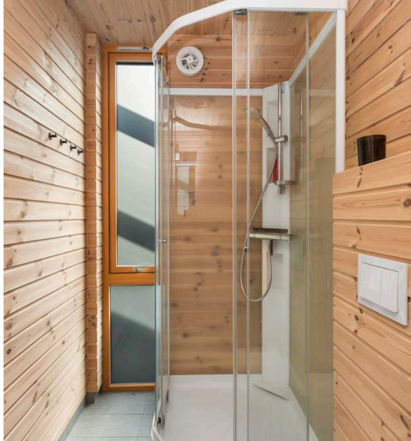
Det er innredet med dusjkabinett, vegghengt wc, servant og skyvedør med hyller til oppbevaring
