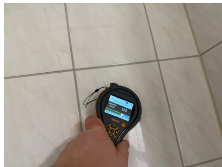
Vegg mot sovealkove, ingen utslag.
