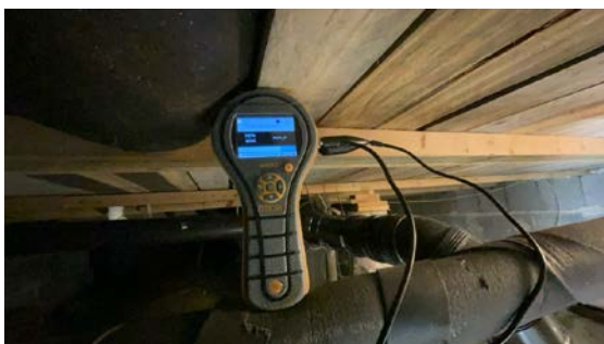
Utført fuktmåling på trevirke mot grunnmur. Lav fuktprosent på befaringsdagen.
