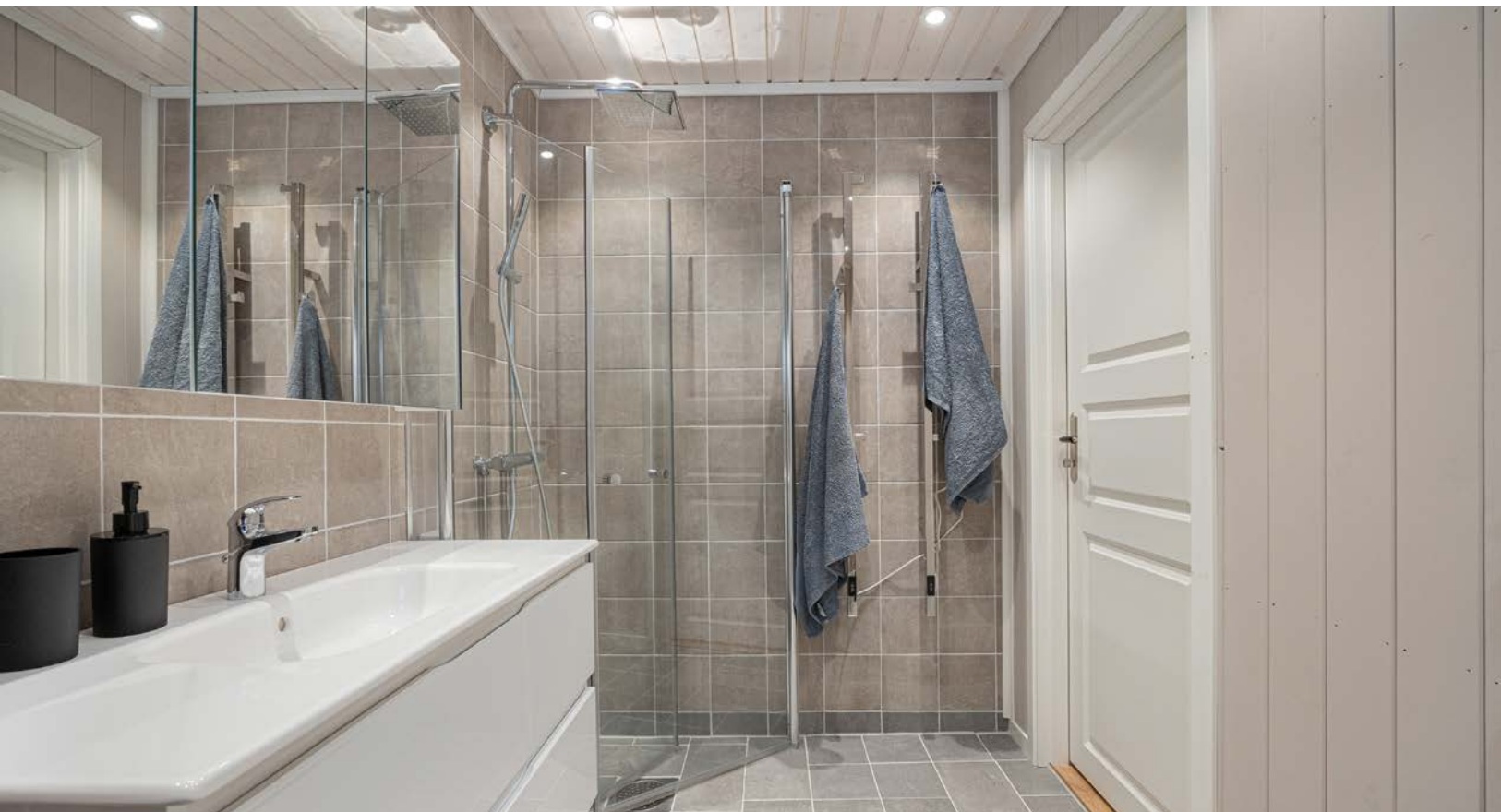
Badet er utstyrt med servant med skuffeseksjon, speilskap, toalett, dusjhjørne med glassvegger, håndklevarmer og opplegg for vaskemaskin. Våtrommet har mekanisk avtrekk og tilluft under dørblad.
