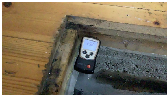
Det måles skadelig fuktinnhold i treverk rundt luke.
