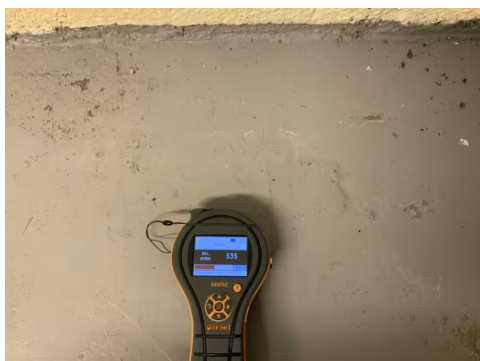
Viser fuksøk på fritt eksponert gulv.
