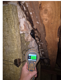
Ingen unormal fukt målt ved eldre fuktmerker rundt pipe.
