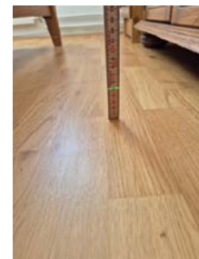
...til 5 cm, 2 meter inn i rom, som er en høydeforskjell på 2,2 cm.
