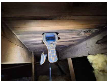
Det ble ikke registrert forhøyede fuktverdier i misfarget taktro.
