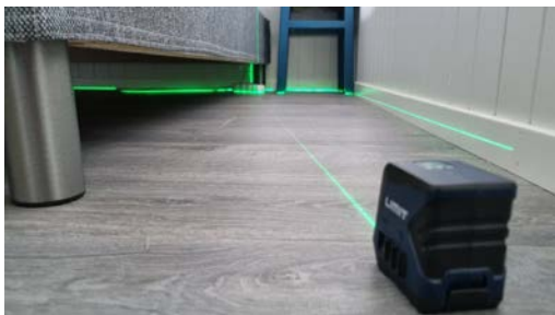
Kontroll av planavvik og skjevheter med krysslaser.
