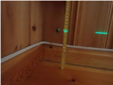
Referansenivå laser = 40 mm. Viser avvik på ca. 90 mm i stue.
