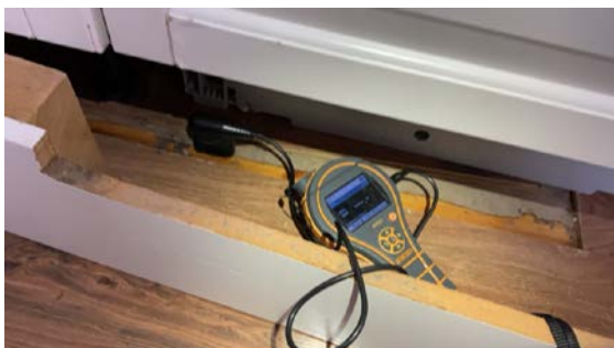
Ved fuktmåletsking av gulv under oppvaskmaskin var det ikke fuktutslag
