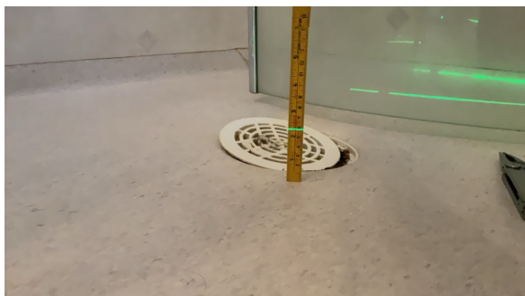
Målt fall til sluk: 6mm.
