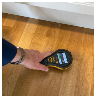
Måling med Protimeter angir normale fuktverdier på gulv foran kjøle - og fryseskap
