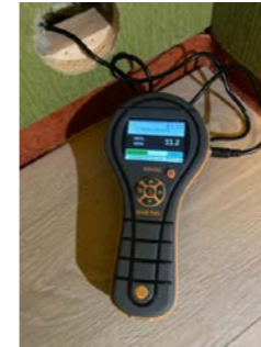
Måling av avfukt i trevirke, med normale verdier.
