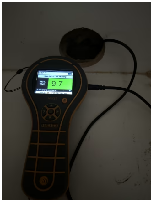
Viser fuktmåling ved hulltaking.
