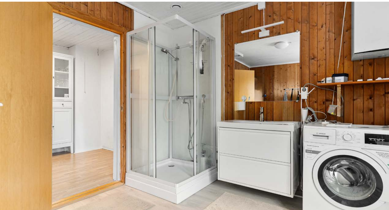
Bad i utleiedelen. Innredet med servant i baderomsinnredning, dusjkabinett og opplegg for vaskemaskin. Rommet er ikke bygget som et våtrom.
