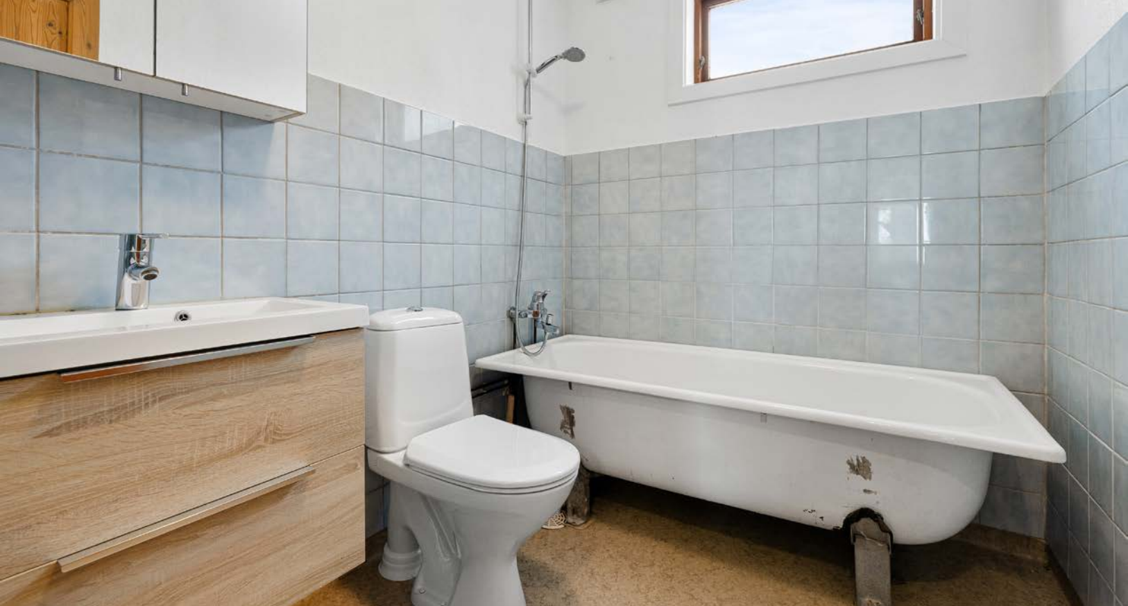
Baderom i 1. etasje med vinylbelegg på gulv og delvis flislagt på vegger.
