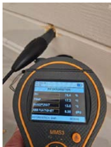
Måling av relativ luftfuktighet i utlektet veggkonstruksjon under terreng.
