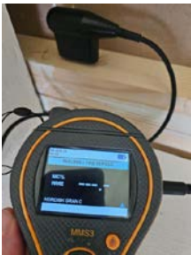
Måling av trefukt i veggkonstruksjon mellom soverom og dusjsone.
