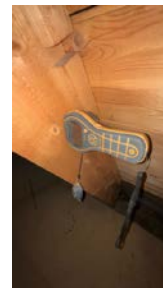
Ved enkel fuktmåling registrerte jeg tørre verdier.
