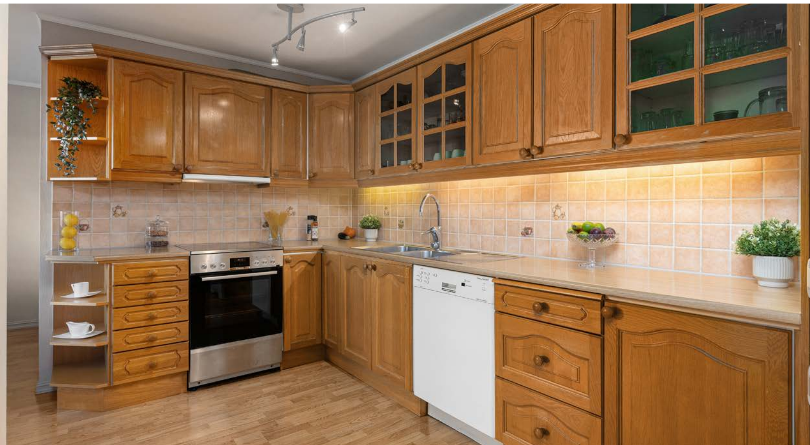
Benkeplater i laminat. Dobbel oppvaskkum med avrenningsfelt og ettgreps blandebatteri. Benkebelysning under overskap
