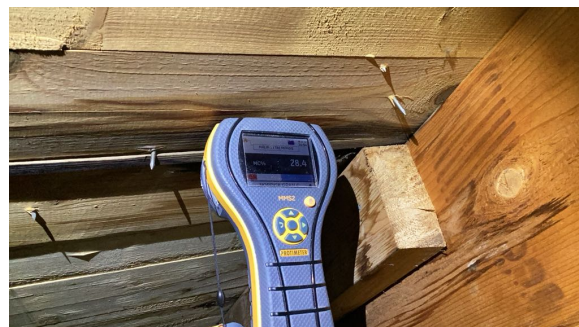
Fuktmåling ble foretatt, jeg målte skadelig fukt på ett punkt ved pipe.
