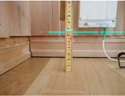
Referansenivå laser = 4 cm. Viser total forskjell på ca. 28 mm.
