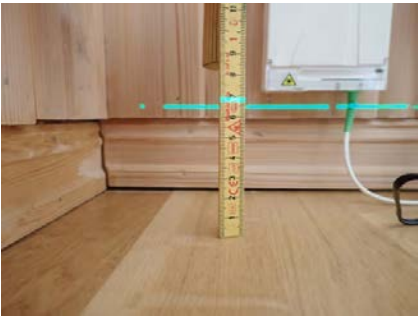
Referansenivå laser = 4 cm. Viser total forskjell på ca. 28 mm.
