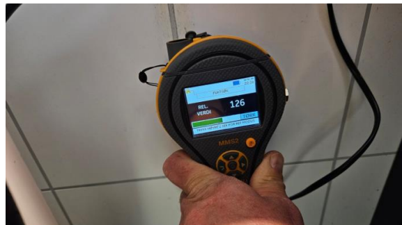
Det ble ved befaring fuktmålt på vegg, ingen forhøyede verdier ble registrert.
