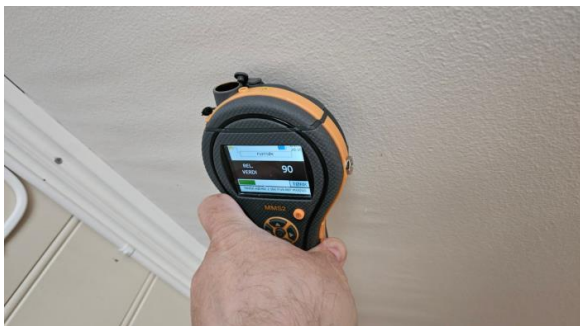
Det er registrert fuktsvell i tak ved pipe på kjøkken. det ble ved befaring fuktmålt, ingen forhøyede verdier ble registrert.
