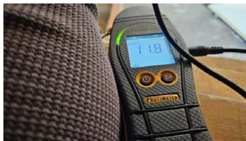
Det ble ved befaring fuktmålt i stubbloftsgulv, ingen forhøyede verdier ble registrert.
