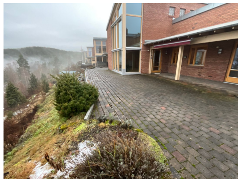
Masser siger ut mot skråning, dette medfører setninger på belegningsstein.
