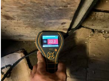
22 vektprosent, nær fibermetting. Fare for skader.
