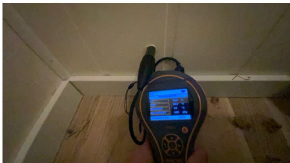
Måling av relativ luftfuktighet i lukket veggkonstruksjon mellom bod og dusjsone.
