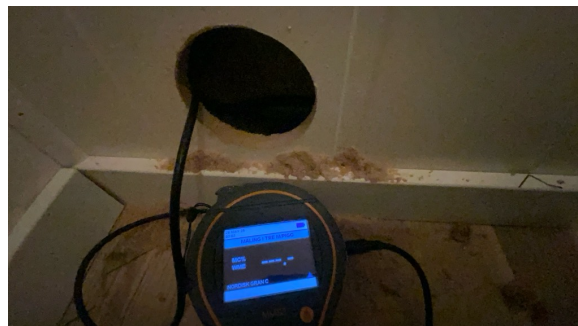
Måling av trefukt i lukket veggkonstruksjon mellom bod og dusjsone.
