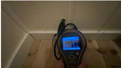
Måling av relativ luftfuktighet i lukket veggkonstruksjon mellom bod og dusjsone.
