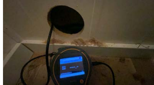
Måling av trefukt i lukket veggkonstruksjon mellom bod og dusjsone.
