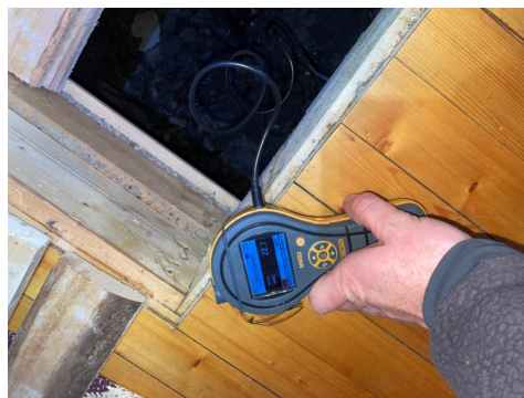
Det måles høyt fuktnivå i treverk med fare for ytterligere skadepotensiale.
