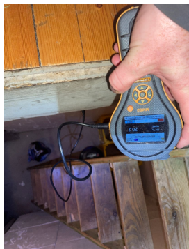
Det måles høy fuktighet i treverk med fare for ytterligere skadeutvikling.
