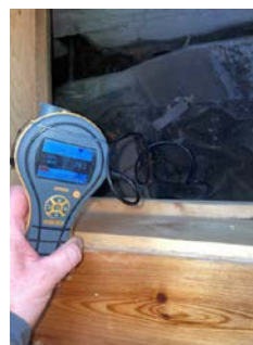
Det måles høyt fuktnivå i treverk med fare for ytterligere skadepotensiale.
