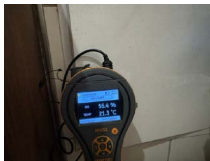
Måling av relativ luftfuktighet.
