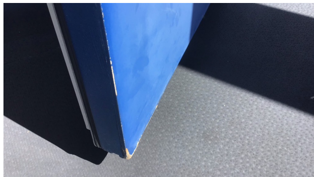
slitasje/bruks merker i nedkant
