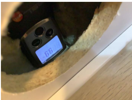
Hulltaking i innredet del, og det måles tørt.
