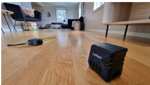
Kontroll av planavvik/ skjevheter i gulv.
