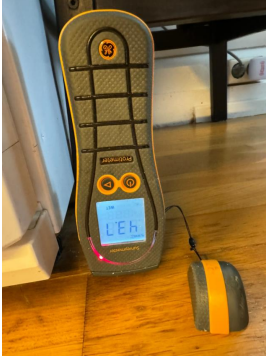
Forhøyede fuktverdier i parkettgulv ved kjøleskap.
