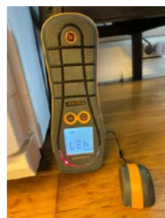
Forhøyede fuktverdier i parkettgulv ved kjøleskap.
