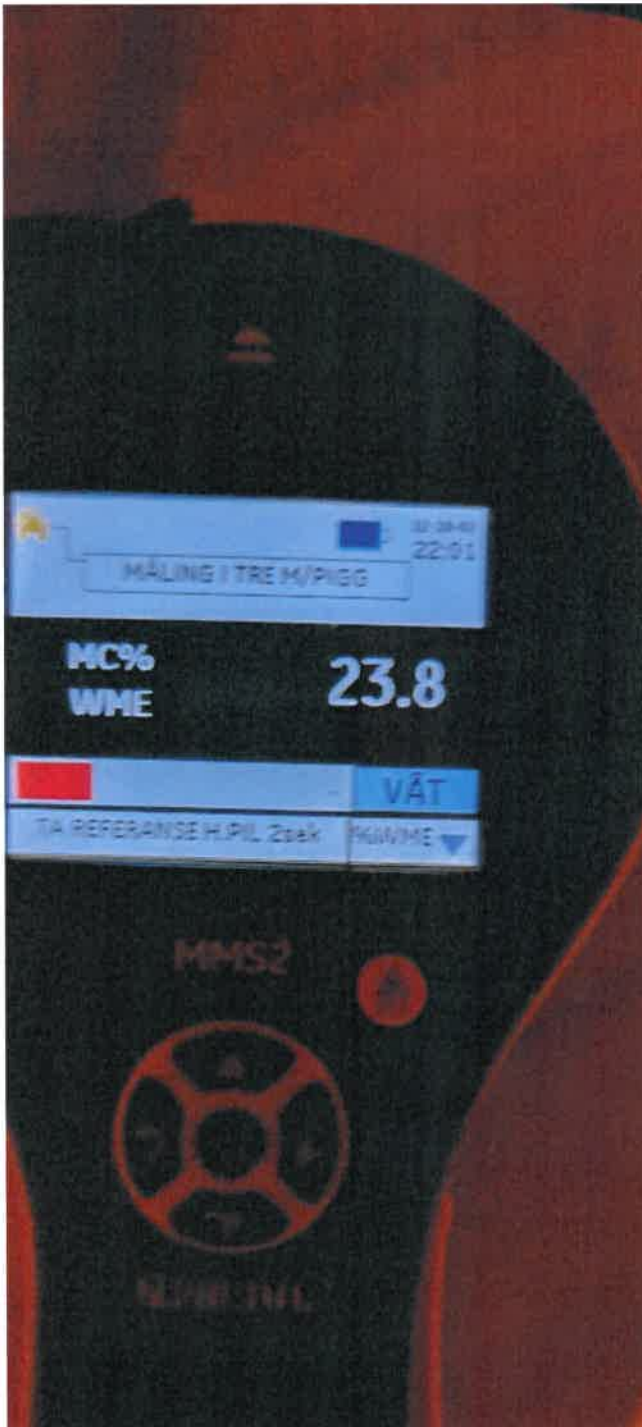
Bilde viser fuktmåler som viser våt.
