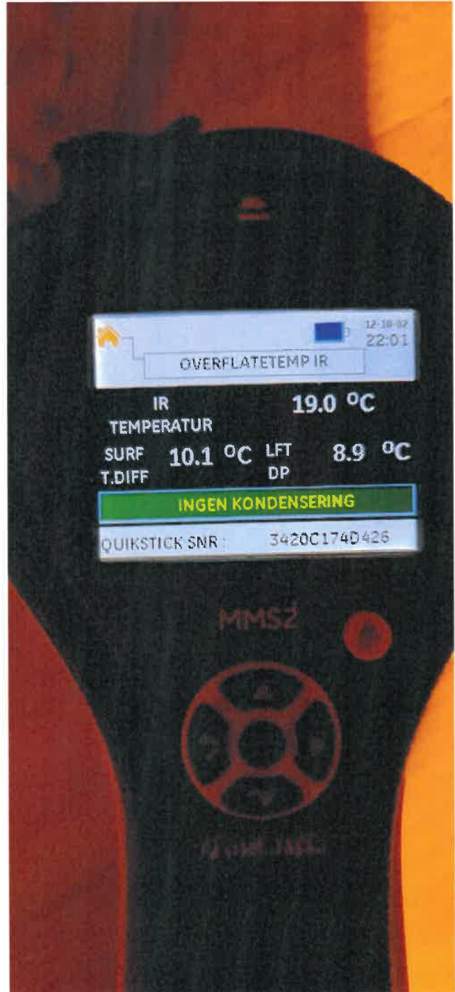
Bilde viser fuktmåler som viser ingen kondensering.
